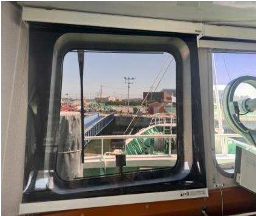
햇빛 차단막 설치 예시 사진
