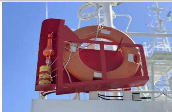
기존 거치대 제거 후 사진과 같은 규격의 거치대로 각각 설치
