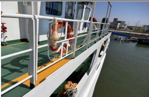
기존 거치대 제거 후 사진과 같은 규격의 거치대로 각각 설치
