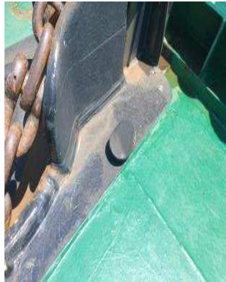
앵커체인을 고정할 수 있는 체인 스톱퍼 설치(현장사진)
