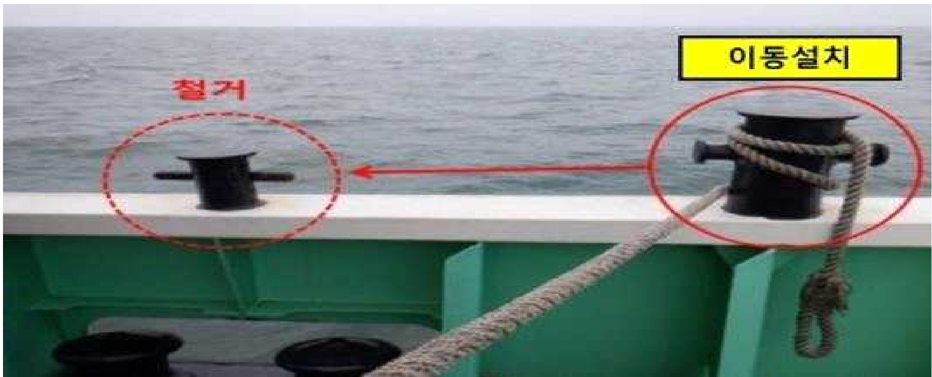
고속단정 계류줄 Cross Bitt 철거 및 선미방향 Cross Bitt 이동설치
